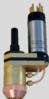
PP-6-02 高效双内送粉系统焊枪 I_{max} = 350 \text{ A}
