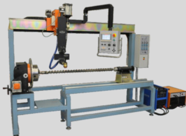
PM-307 通用PTA系统，主要用于堆焊长轴零件
